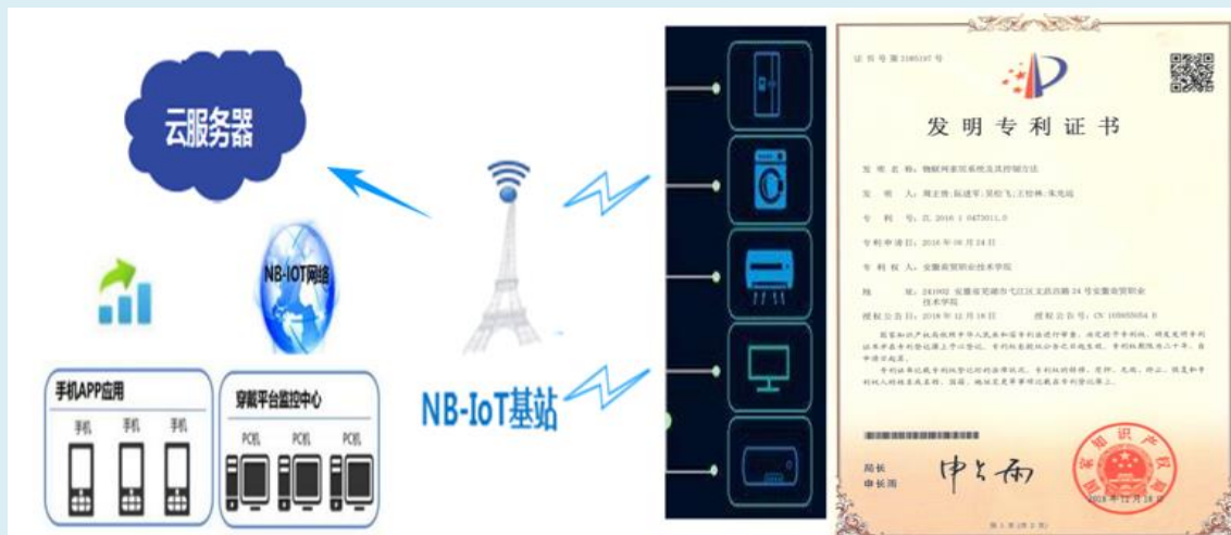
图 4-6 基于 NB-IOT 技术的智能家居系统架构图与发明专利证书
